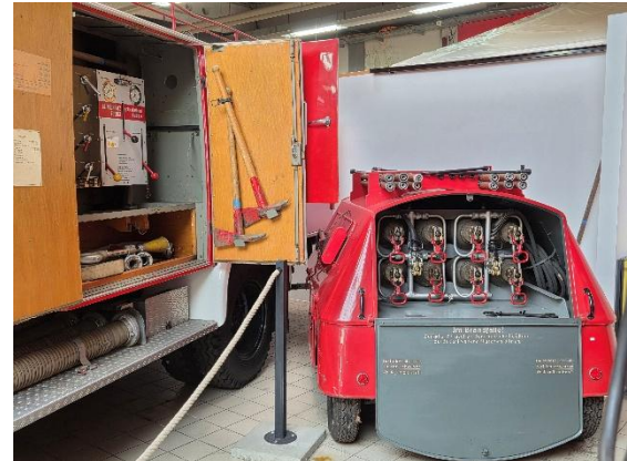
Die Pulverlöschanlage am TroTLF 16 ist zur Besichtigung zugänglich gemacht worden.
